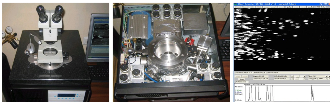
Рис. 10. Микроскоп сканирующего анода «SAFEM» (слева) со встроенной вакуумной системой ( p \sim 1 \times 10^{-9} мбар, по центру) и изображение ( 400 \text{ мкм} \times 200 \text{ мкм} ) эмиссии углеродного образца с графеновыми выступами (справа).
