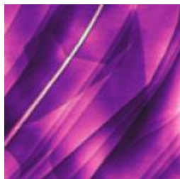
Атомные слои на графите. Размер скана 1.8×1.8 мкм. АМ АСМ
