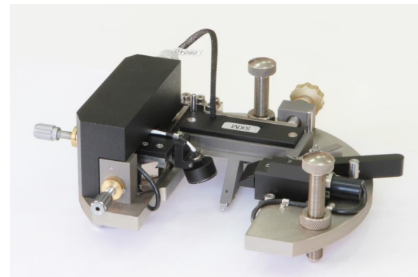
Измерительная ACM-головка с доступом для параболического зеркала
