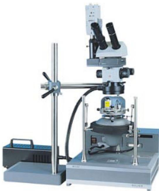
Рис.1. Пьезомеханический блок (виброзащитная система, блок сканера и измерительная головка) сканирующего зондового микроскопа Solver P47
