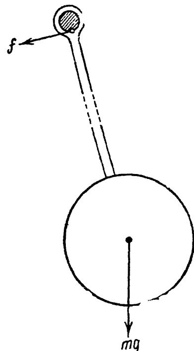
Рис. 5. Схематический чертеж маятника Фроуда
