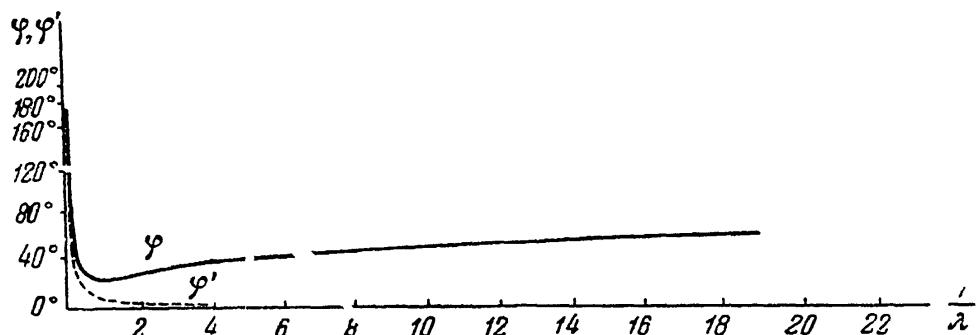
Рис. 1. Зависимость дополнительной фазы  $\varphi$  вертикальной компоненты электрического вектора поля радиоволн от расстояния до излучающего диполя для длины волн  $\lambda = 300$  м и проводимости почвы  $\sigma = 5 \cdot 10^7$ ;  $\varphi'$  — то же для предельного случая бесконечной проводимости земли
