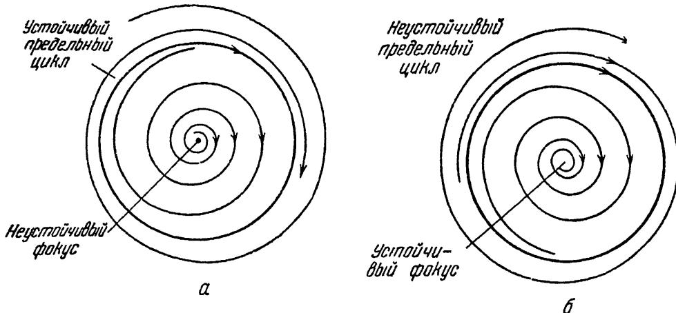
Рис. 3. Предельные циклы и схема хода интегральных кривых
