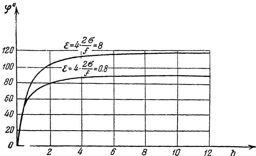
Рис. 3. Зависимость изменения фазы  $\Delta\phi$  (в градусах) вертикальной компоненты электрического вектора от высоты над земной поверхностью, выраженной в длинах волн
