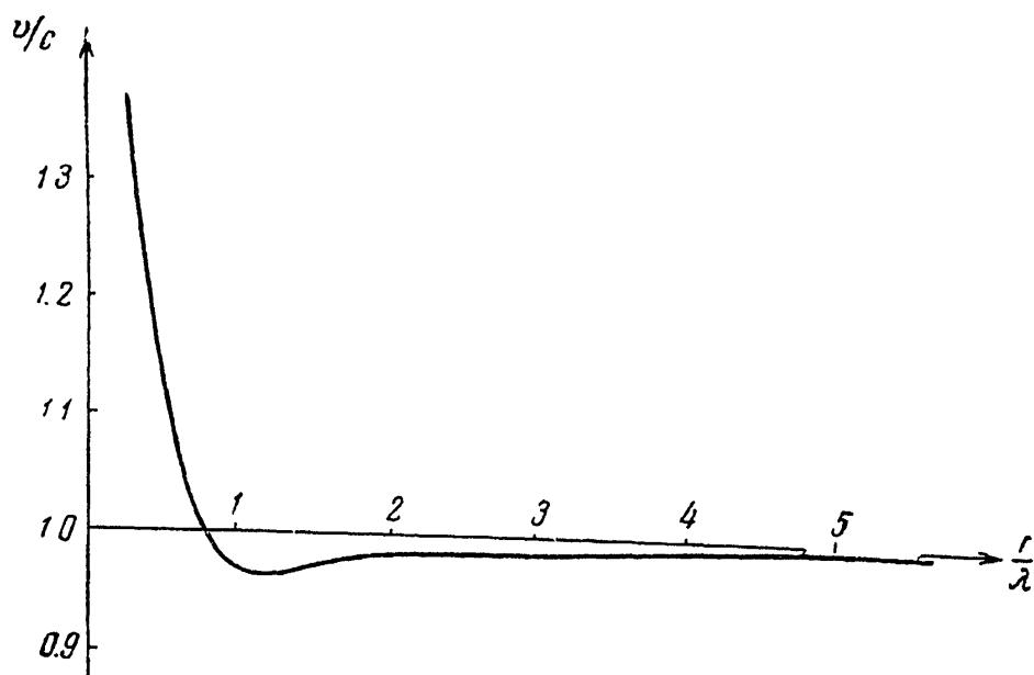
Рис. 2. Зависимости дифференциальной фазовой скорости  $v^*$  электрического вектора от расстояния до излучающего диполя в длинах волн  $\sigma = 5 \cdot 10^7$ ,  $\lambda = 300$  м и  $\epsilon = 10$
