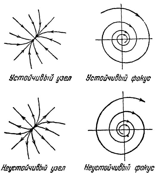
Рис. 1. Характерные типы особых точек и схема поведения интегральных кривых вблизи этих точек. Устойчивый узел, например, соответствует апериодическому разряду конденсатора, устойчивый фокус — колебательному разряду конденсатора
