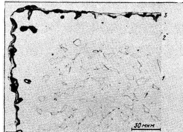
Рис. 5.16. Обедненная хромом зона для сплава Ni — 50 Cr, окисленного в течение 21 ч при 1100 °С в кислороде:
