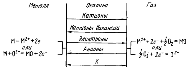
Рис. 3.9. Упрощенная модель окисления, контролируемого диффузией
