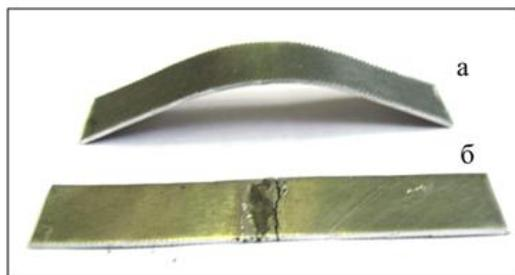
Рис.1. Исходный алюминиевый образец (а) и образец с полоской галлийсодержащего расплава (б) после приложения изгибающей нагрузки.
