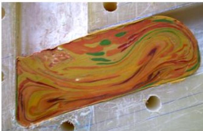
Рис. 1. Пластилиновый образец с исходной кольцевой сеткой после трёх проходов РКУП по маршруту С в штампе с  $2\theta=75^\circ$ ,  $\varphi=0^\circ$
