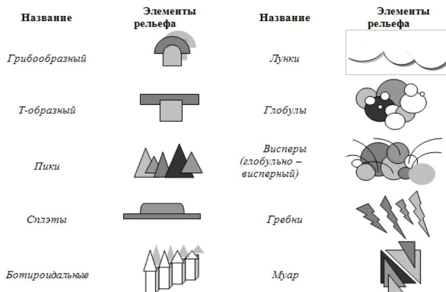
Рис. 1. Виды элементов рельефа микроповерхностей.
