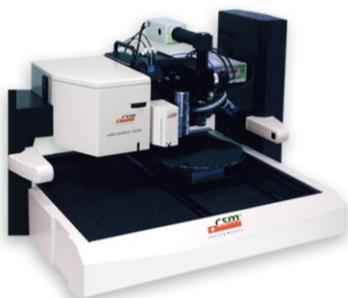
Настольный нанотвердомер на открытой платформе с нано-скретч тестером, AFM и оптическим микроскопом
