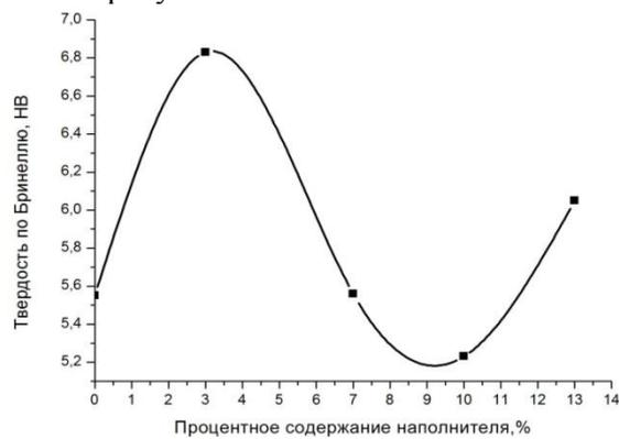
Рис. 5 График зависимости твердости по Бринеллю от процентного содержания наполнителя в композициях
