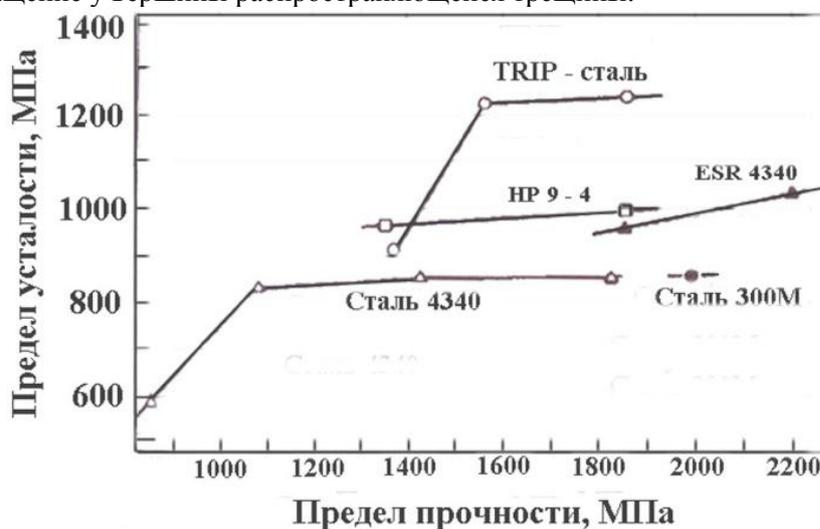
Рис. 1. Зависимость предела выносливости высокопрочных сталей от уровня предела прочности [7].
