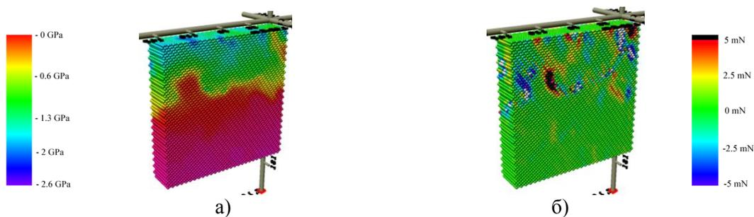
Рис. 1. «Гидростатические» напряжения (а) и распределение моментов сил (б) в образце с зеренной структурой при интенсивном тепловом воздействии.
