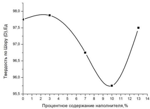
Рис. 3 График зависимости твердости по Шору от процентного содержания наполнителя в композиции
