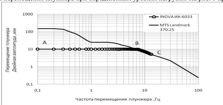
Рис. 1. Фрагмент амплитудно-частотной характеристики машины INOVA ИК-6033.
