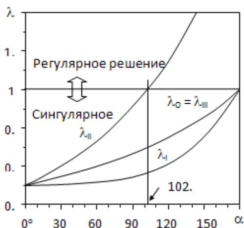
Рис.3. Минимальные значения характеристических уравнений для пластины с V-образным вырезом в случае силовых граничных условий на берегах выреза
