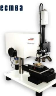
Скретч-тестер на компактной платформе и Revetest
