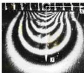
Рис.2. Картина Муаровых полос после взрывной обработки для последующей расшифровки.
