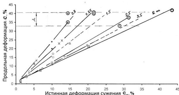
Рисунок 1. – Распределение локальных продольных истинных деформаций  $e$  в зависимости от величины макродеформаций  $e_p$  при различных радиусах  $R$  в вершине надреза деформируемого сплава. Значения  $R$  указаны около соответствующих кривых. Д – область разброса значений предельных продольных локальных деформаций (отмечены кружочками).
