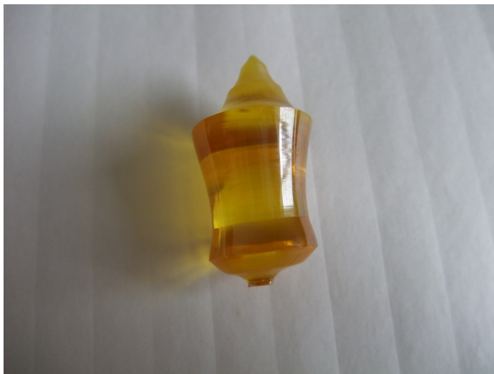
Fig. 2.5 The grown \text{Re}^{3+}:\text{NaY}(\text{WO}_4)_2 crystals ( \text{Re}=\text{Tm}/\text{Ho} ).
