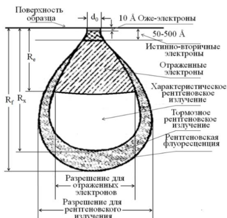
Рис. 3.10. Область взаимодействия электронов зонда свеществом образца. d_0 – размеры зонда на поверхности образца; R_e , R_x , R_f – глубины выхода ответных сигналов электронов, характеристического, тормозного рентгена, флюоресценции соответственно. Для Оже-электронов и истинно-вторичных электронов указаны ориентировочные величины глубины выхода.
