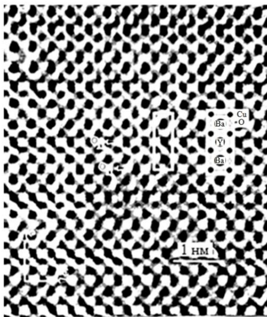
Рис.2.14. Изображение структуры монокристалла \text{YBa}_2\text{Cu}_3\text{O}_{6,74} вдоль направления оси b.
