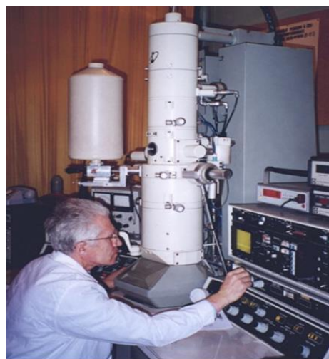
б) – Современный электронный микроскоп фирмы JEOL Япония (рабочее напряжение 100 kV)
