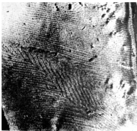
Рис.3.7. Изображение магнитных доменов на рентгеновской топограмме (метод Ланга) монокристалла железо-иттриевого граната [20]. Толщина кристалла - 180мкм, излучение AgK\alpha , отражение (800), время экспозиции - 60час.
