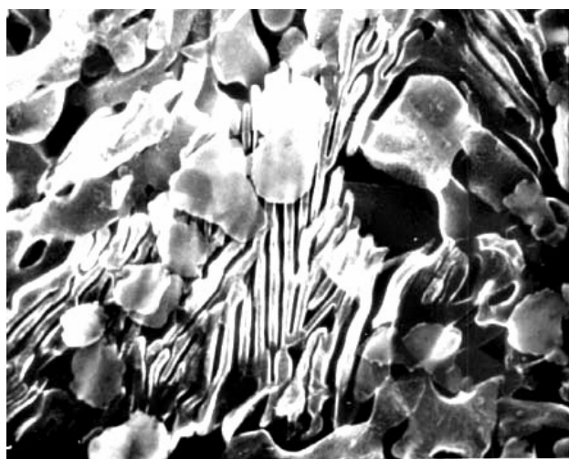
Рис.5.17. SEM изображение поверхности эвтектоидного сплава 22\%Al-Zn после 920 часов отжига. Наблюдаются чередующиеся пласти \alpha и \beta фаз разделенных когерентными границами.
