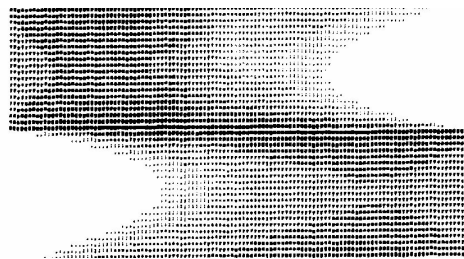
Рис.3.11. Рассчитанная на ЭВМ секционная топограмма с изображением винтовой дислокации, параллельной вектору отражения. \mu t=10 .
