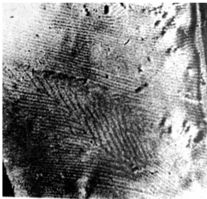
Рис.3.6. Изображение магнитных доменов на рентгеновской топограмме (метод Ланга) монокристалла железо-иттриевого граната. Толщина кристалла - 180 мкм, излучение \text{AgK}_{\alpha} , отражение (800), время экспозиции - 60 час.
