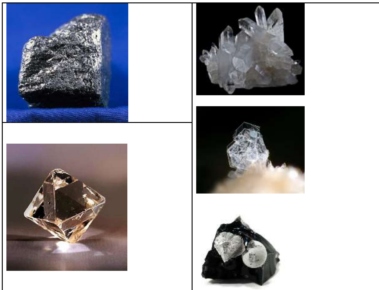
Рис. 2.2. Примеры полиморфных модификаций одинаковых химических элементов и соединений, имеющих разные физико-химические свойства. Слева углерод в виде графита и алмаза, справа диоксид кремния ( \text{SiO}_2 ) в виде кварца, тридимита и кристобалита.
