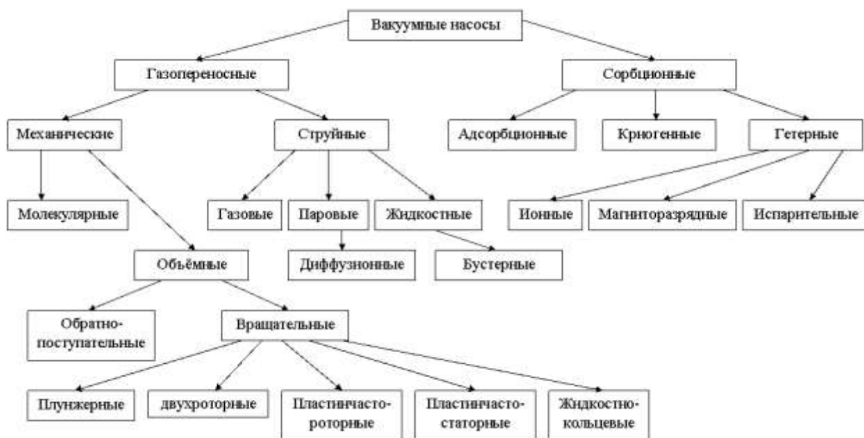
Рис. 12.1. Типы вакуумных насосов по принципам их действия
