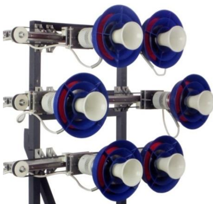
Рис. 2. Внешний вид разработанного многоэлементного УЗ излучателя
