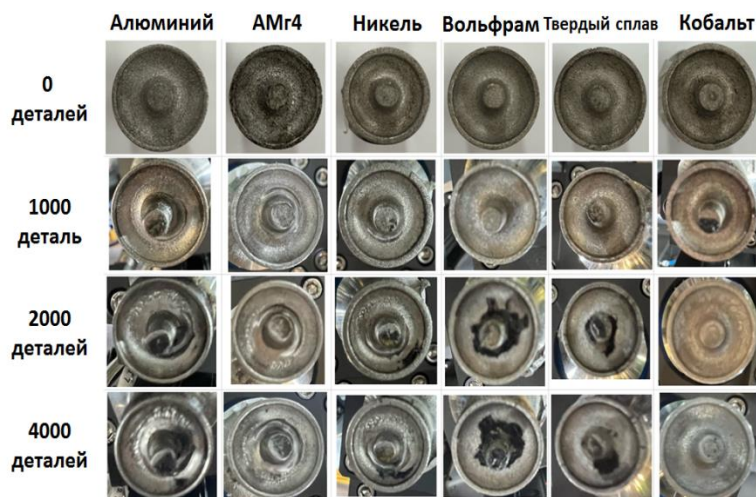
Рис. 1. Изношенные торцы волноводов с различными покрытиями
