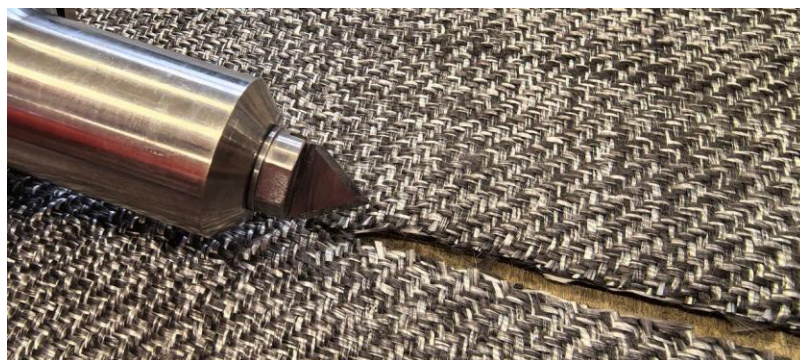
Рис. 4. Ультразвуковая резка с использованием оборудования ООО «ИНЛАБ – Ультразвук»
