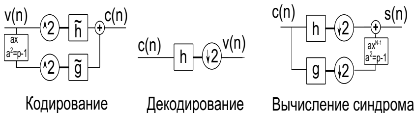
Рис. 1: помехоустойчивое кодирование с использованием биортогональной двухканальной схемы анализа-синтеза
