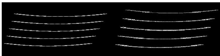
Рис. 1: результаты моделирования ЭЛИ без синтезирования при отсутствии траекторных нестабильностей (слева) и с ними (справа). Модельная сцена состоит из цепочки точечных отражателей
