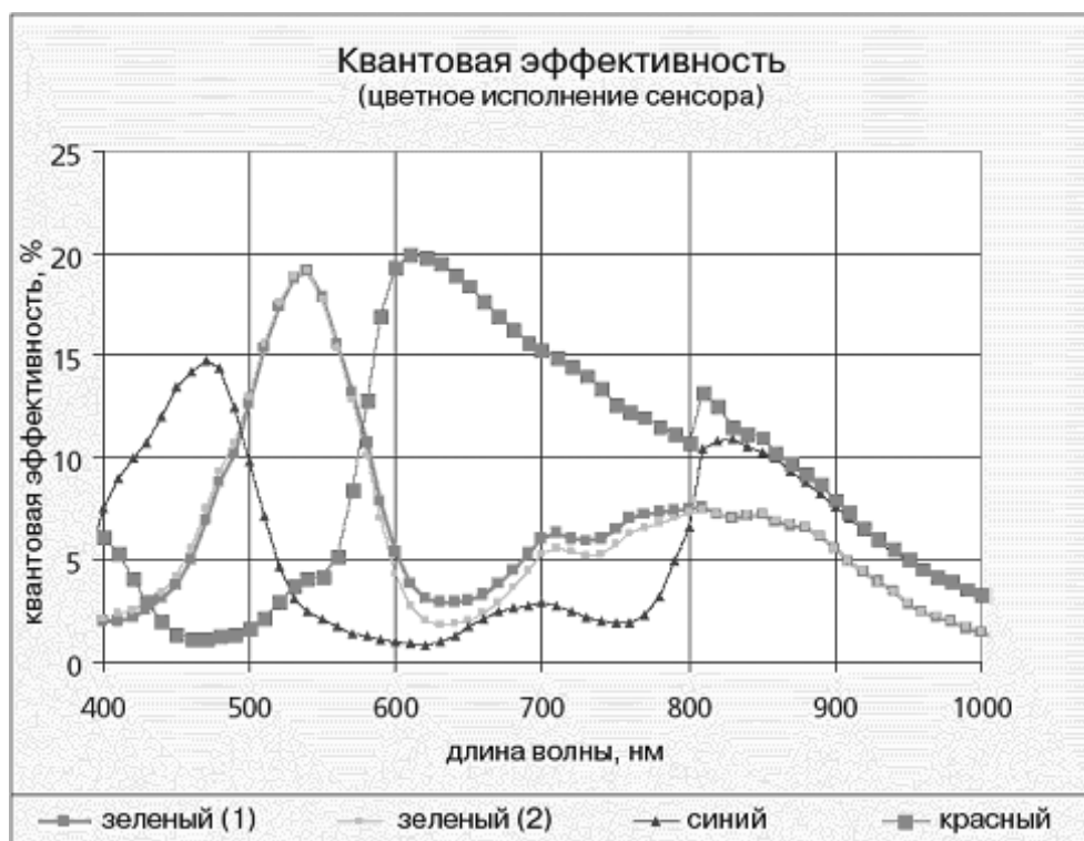
Рис. 2. Квантовая эффективность матрицы камеры
