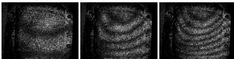
Рис. 5. Характерный вид температурной деформации пластины прямоугольной рамке с равномерной жесткостью закрепления по краям
