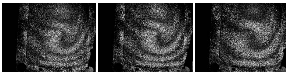
Рис. 7. Характерный вид интерферограммы температурной деформации поверхности пластины с дефектом в виде лунки на обратной стороне
