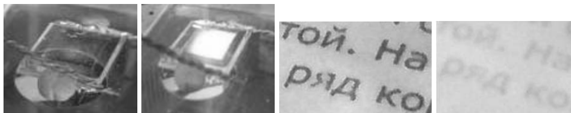
Рис.7. Модулятор рассеяния света, выполненный на смектической наноструктуре СЖК-576, толщина слоя СЖК - 30 \mu\text{м} , шаг спирали p_0=165 нм. Слева направо: прозрачное состояние модулятора (управляющее напряжение выключено), модулятор работает в режиме переходного рассеяния, прозрачное состояние модулятора (управляющее напряжение выключено), модулятор работает в режиме переходного рассеяния на частоте 450 Гц (прозрачное и рассеивающее состояния модулятора чередуются через равные интервалы времени)
