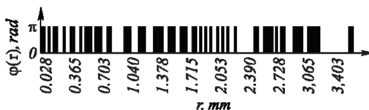
Рис.2. Фаза бинарного ДОЭ, формирующего осевое распределение интенсивности
