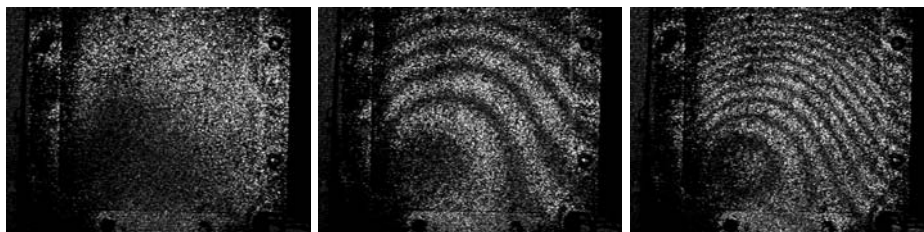
Рис. 4. Характерный вид температурной деформации пластины в прямоугольной рамке с неравномерной жесткостью закрепления
