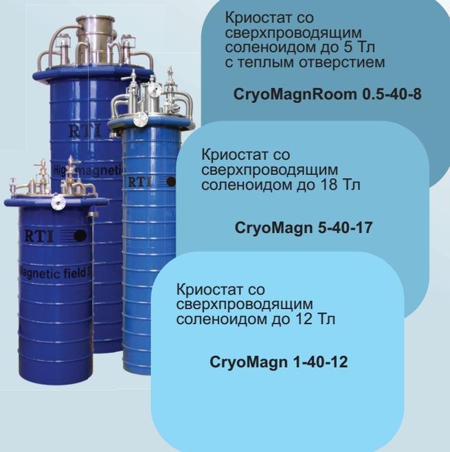
Криостат со сверхпроводящим соленоидом до 5 Тл с теплым отверстием
