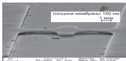
Рис. 1. Изображение мембраны, полученное с помощью электронного микроскопа
