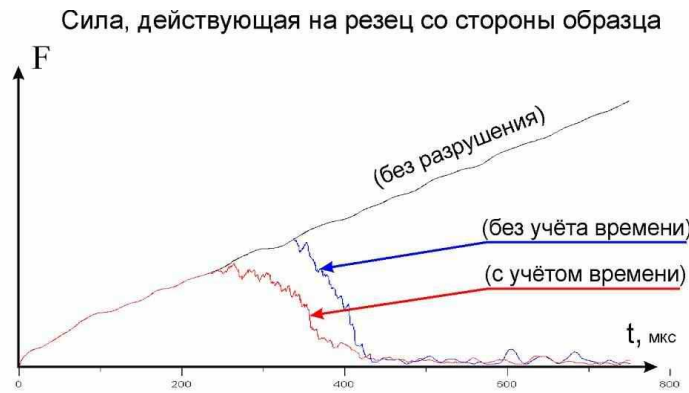
Рис. 3. Зависимости усилия резания от времени а) – без разрушения; б) – критерий наибольших растягивающих напряжений; в) – двухуровневый критерий разрушения.
