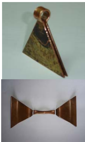
Рис. 1. Одновитковая катушка до и после импульса.
