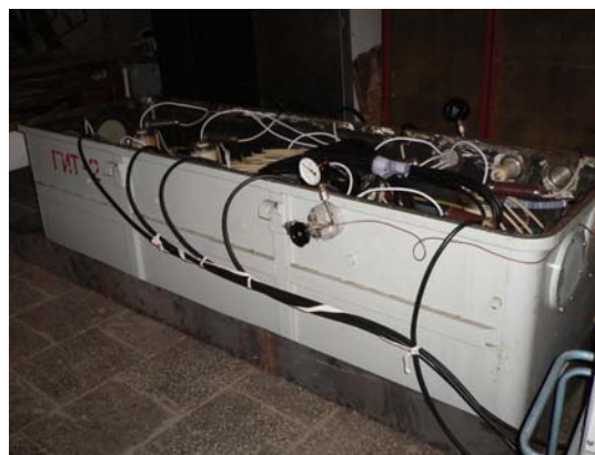
Рис. 2. Генератор импульсного тока ГИТ-100.
