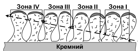
Рис. 3. Схематическое представление наностолбиков, на котором указаны исследованные зоны и плоскость формирования тонкой фольги под наклоном относительно подложки (штриховая линия)
