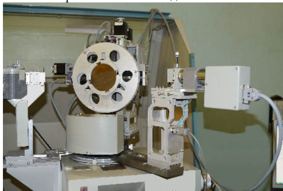
Рис.3. Двухкристальная приставка ПДП к рентгеновскому дифрактометру ДРОН-3.
