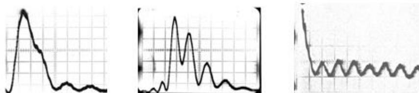
**Рис. 1.**  $V(Z)$ -кривые керамики, стекла, стали (для определения значений скорости ПАВ и уровня её затухания). По вертикали – амплитуда отраженного сигнала, по горизонтали – расстояние акустическая линза – поверхность изучаемого объекта ( $Z$ )
