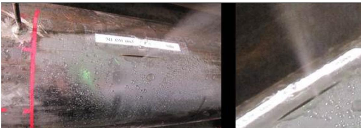
Рис. 1. Разрушение (утечка среды) трубы  $D_y630$  при давлении ГИ  $P=90$  кг/см<sup>2</sup>
