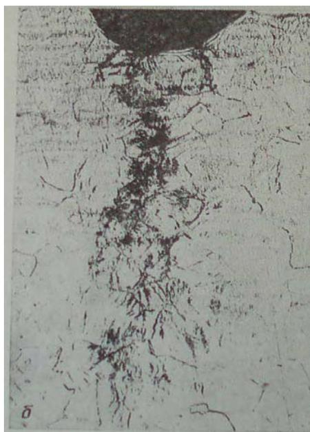
**Рис.2.** Развитие сети микротрещин перед надрезом образца Шарпи после выдержки под нагрузкой (при 0,8 предела текучести) через 5 мин в стали 30X9H8M2ГC2; x50.
