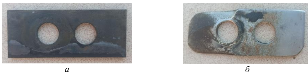
Рис.1. Молоток дробилки ДМ-10. а – новый, б – после эксплуатации
