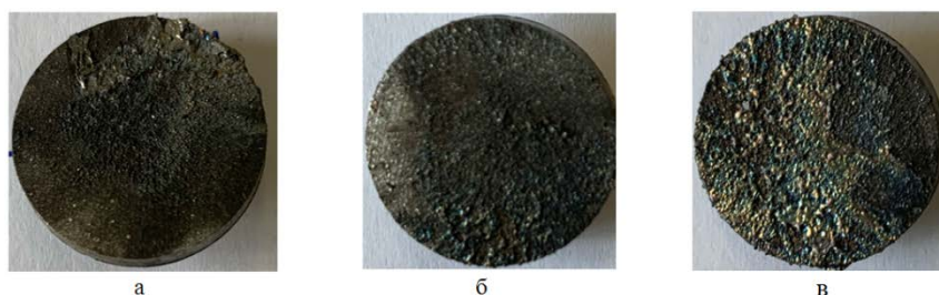
Рис. 1. Внешний вид поверхности молибденовых покрытий, полученных в режимах электровзрывного напыления 1 (а), 5 (б) и 8 (в)
