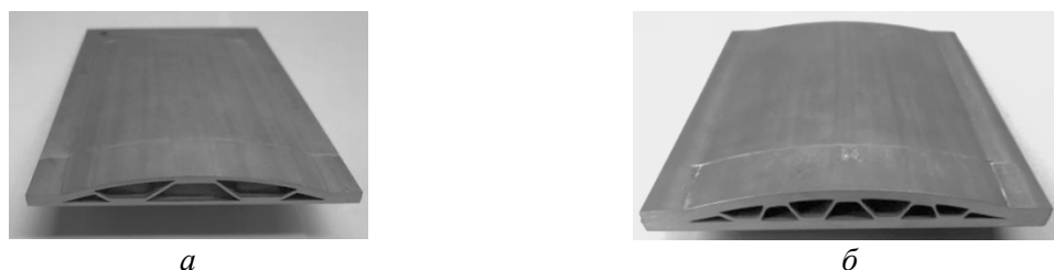
Рис. 2. Трехслойная полая плоская конструкция, полученная методом СПФ/ДС из листовых титановых сплавов ВТ6 при T = 750^{\circ}\text{C} ( а ) и VST2k при T = 800^{\circ}\text{C} ( б )
