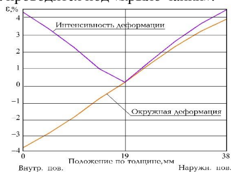
Рис. 1 – Остаточная деформация при производстве трубы
