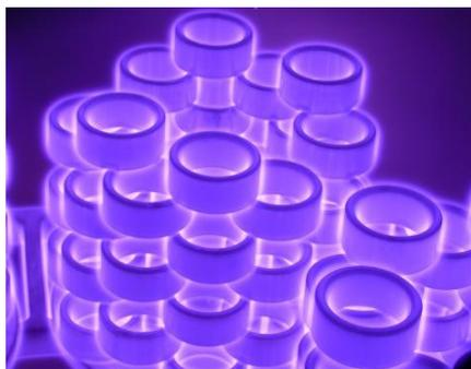
Рисунок 1 - Вид деталей в процессе ионного азотирования
