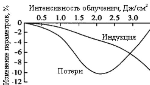
Рисунок 2 - Зависимость величины магнитной индукции  $B_{100}$  и магнитных потерь  $P_{1,7/50}$  от интенсивности локального лазерного воздействия
