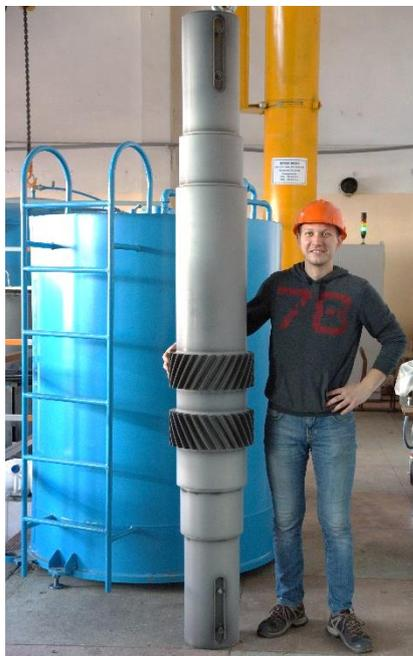
**Рисунок 2 - Вал-шестерня из стали 40ХН2МА после ионного азотирования**
