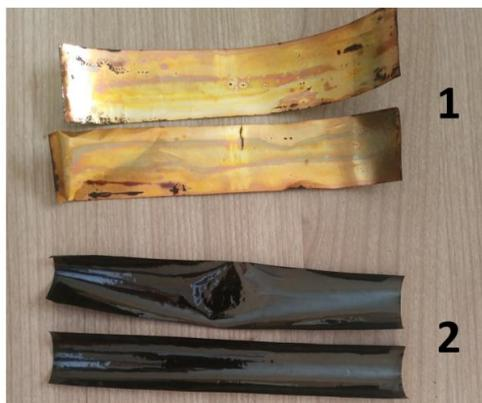
Рисунок 1 - Исходные медные пластины (1), пластины с покрытием из МГ (2)
