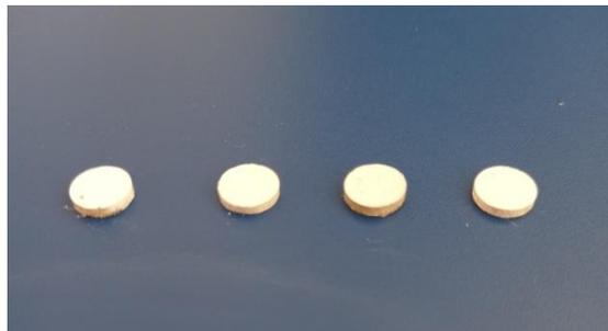
Рисунок 3 – Вид спрессованных таблеток  $\text{Na}_{0,5}\text{Bi}_{0,5}\text{TiO}_3$
