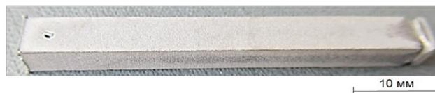
Рисунок 1 - Композитный стержень Nb-30Ti/Al из фольг сплава Nb-30%Ti и Al с электрохимическим (Cr + HA)-покрытием из хрома с нано-алмазными частицами: отверстие и выемка на торцах предназначены для подсоединения стержня в электрическую цепь при нанесении покрытия
