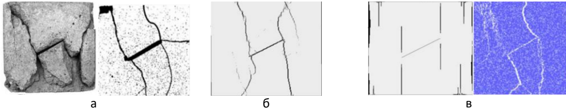
Рисунок 1 – Верификация SPH-модели на одноосном сжатии образца с исходной трещиной: сопоставление картины разрушения (б) с экспериментом (а) и альтернативными численными расчетами (в).
