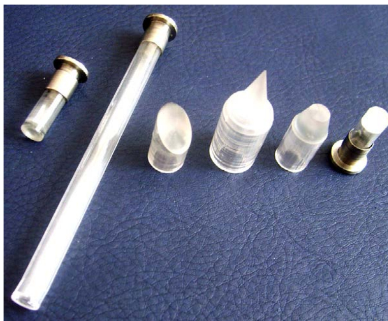
Рис. 9. Сапфировые наконечники для контактных криодеструкторов.
