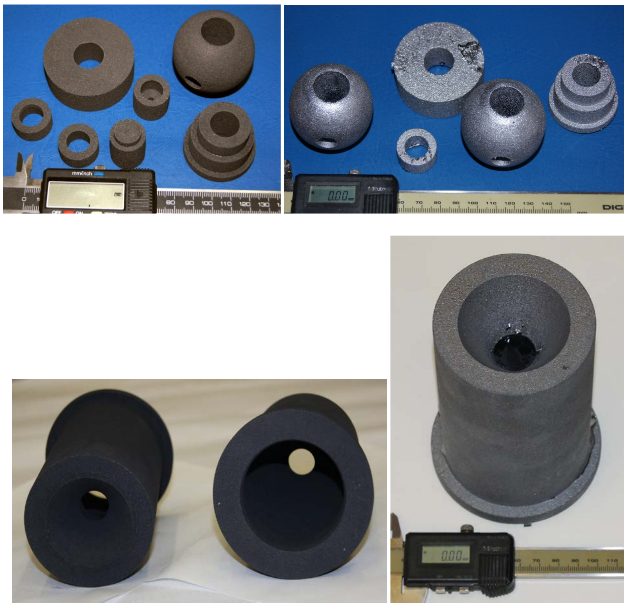
Рис. 4. Углеродные заготовки после механической обработки (слева) и соответствующие им карбидокремниевые заготовки после силицирования (справа).
