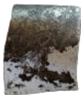
Рисунок 1 – Образец с неравномерным покрытием никеля.
