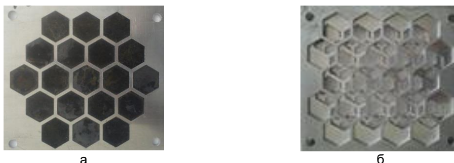
Рисунок 2 – Отдельный слой (а) и комплект пластин для формирования гибридного материала (б)
