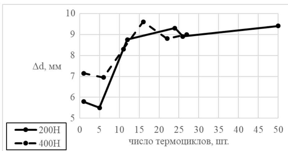
Рисунок 1 – Эволюция формоизменения в режиме ЭПФ в результате термомеханической обработки КСПЭ
