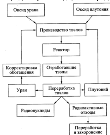
Рисунок 1 – Процесс переработки отработавшего топлива при использовании МОКС-технологии на тепловом реакторе
