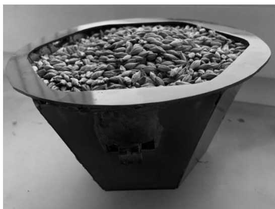
Рисунок 2 – Конструкция датчика влагомера
