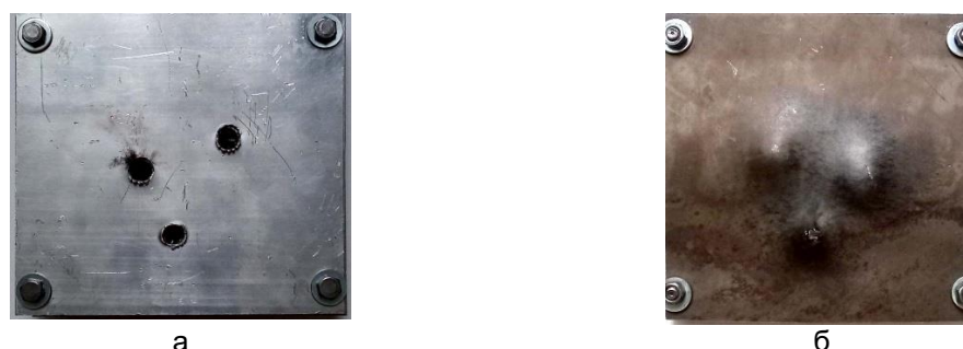
Рисунок 3 – Результат воздействия поражающих элементов на экспериментальный образец
