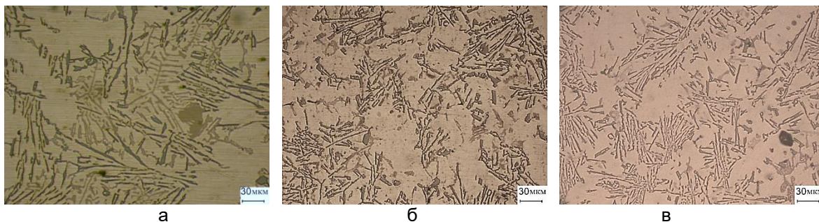
Рисунок 2 – Структура сплава АК12М2МгН до (а) и после модифицирования нанонаполнителем 1,8% \text{TiC}-\text{Al}_2\text{O}_3 (б) и 2,5% \text{TiC}-\text{Al}_2\text{O}_3 (в) после литья в стальной кокиль
