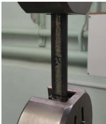
Рисунок 1 – Схема испытаний образцов из стали 35 на растяжение
