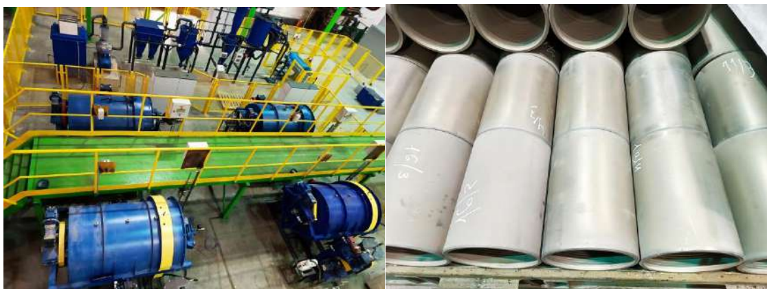
Рисунок 1 – Участок нанесения термодиффузионных покрытий и оцинкованные муфты на АО Выксунский металлургический завод («ВМЗ»)
