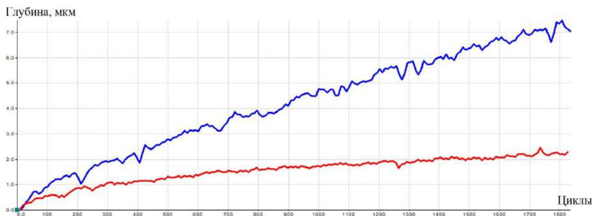
Рисунок 2 – График интенсивности износа при истирании с нормальной нагрузкой 500 мН поверхности образца титанового сплава ВТ6 без модификации (синяя линия) и модифицированной минералами (красная линия) [3]
