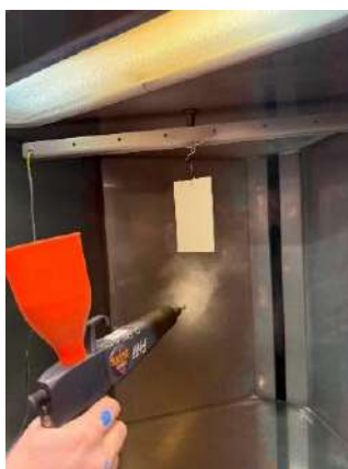
Рисунок 4 – Нанесение порошковых покрытий в электростатическом поле
