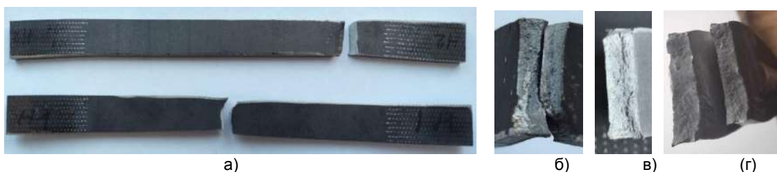
Рисунок 5 – Образцы N1, N2 после разрушения (а), сечения разрушения образцов N1(б), N2 (в), 14.2, 14.3 (г)
