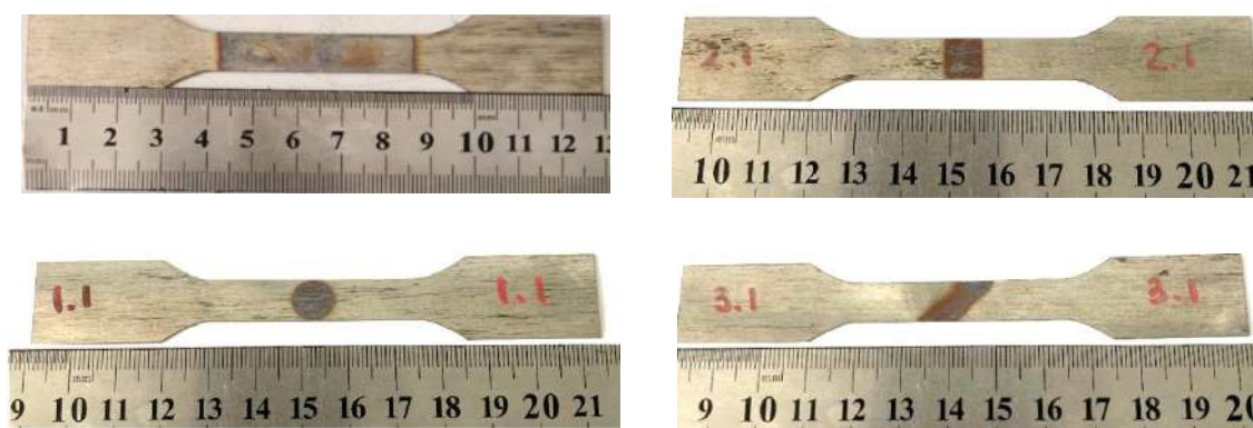
Рисунок 1 - Образцы с композитной структурой, подготовленные для механических испытаний
