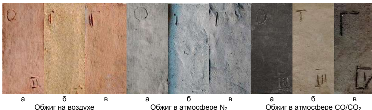
Рисунок 1 – Влияние среды обжига на цвет изделий из глин, различных месторождений: а) «Заполье»; б) «Туровское»; в) «Городное»
