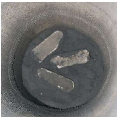
Рисунок 3 – Контейнер с образцами в смеси для термодиффузионного цинкования
