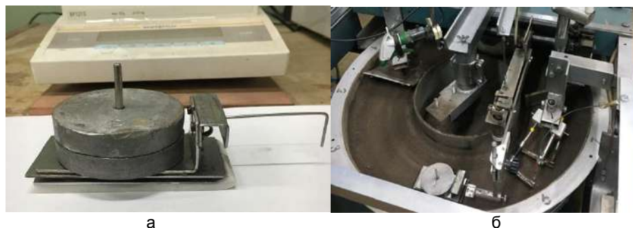
Рисунок 2 – держатель образца с грузами, поводком и образцом на магнитном креплении (а) и (б) карусельный стенд для исследования трибологических параметров функциональных покрытий при трении о модельный грунт
