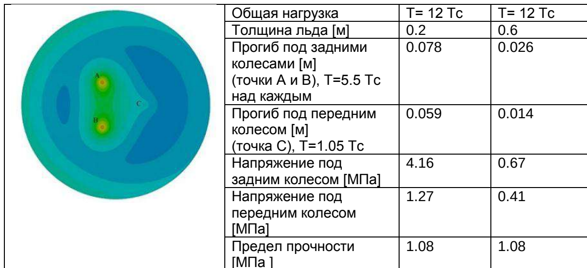
Рисунок 3 – Распределение радиальных напряжений в случае трех сосредоточенных вертикальных нагрузок. Данные расчета в таблице справа.
