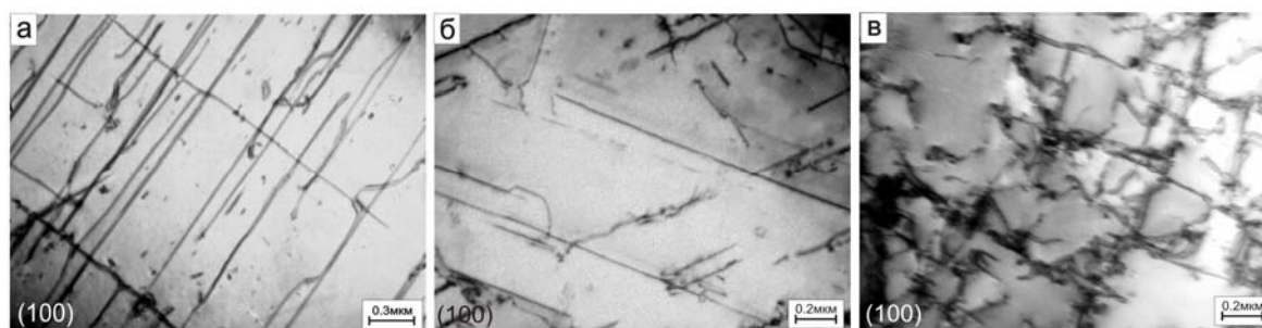
Рис.1. Дислокационная структура \text{Ni}_3(\text{Al, Nb}) (а, б) и \text{Ni}_3\text{Fe} (в) после: а – деформации при 77 К и отогрева при 473 К, 1 час; б – деформации при 1073 К и отогрева при 473 К, 1 час; в – деформации при 77 К и отогрева при 523 К, 1 час
