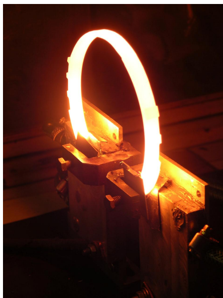
Рис. 4. Нагреватель из керамики на основе карбида кремния с антикоррозионным покрытием из SiC нанокристаллитов
