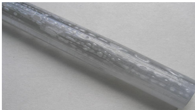
Рис. 3. Разрушение приповерхностного слоя стержня, выращенного из сырья III класса, после отжига в вакууме ( -30 кДж/моль, T = 1950 °С).
