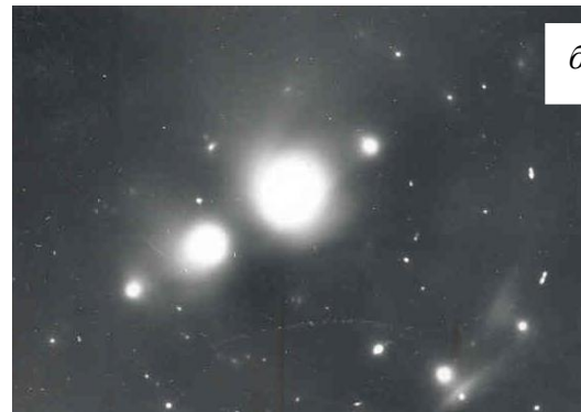
Рис. 2. Структура в шейке ТО образца, деформированного при 1100°C.
