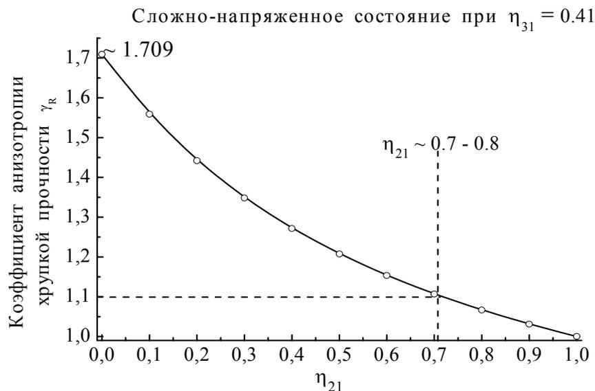
Рис.2. Зависимость коэффициента анизотропии хрупкой прочности  $\gamma_R$  от вида напряженного состояния (прокатка, идеальная текстура (001)<110>)
