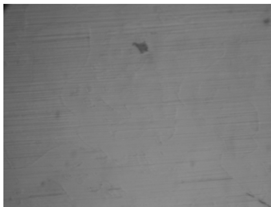
Рис. 2. Валок № 5884 – сульфид компактной формы, x500
