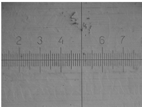
Рис. 1. Валок № 5884 – розетка графита на глубине 9 мм от поверхности бочки, x100
