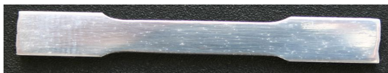
Рис.1. Монокристалл алюминия (41х3,8х1,8 мм)
