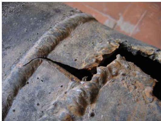
Рис.1. Продольные трещины в основном металле.
