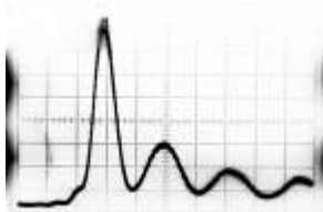
Рис. 2. Акустическое изображение приповерхностных слоев полупроводникового материала ((Ge <111>), f = 404 МГц, Z_a = -19 мкм, масштаб 18 мкм/дел.)
