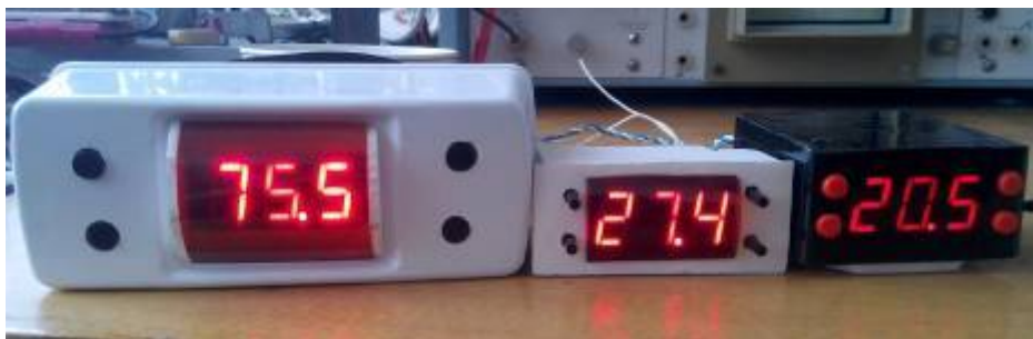
Рис. 1. Прибор для непрерывного измерения и контроля температуры на основе кремния с нанокластерами атомов никеля
