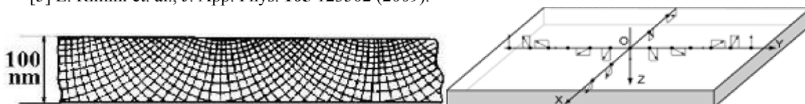
Рис. 1. схема внутреннего изгиба плоскостей решётки, показанная в сечении кристалла (слева, условно выделены 2 системы кристаллографических плоскостей, 1 линия на 20 плоскостей, изгиб преувеличен для наглядности) и соответствующая схема расположения ориентировок кристаллической решётки транслотационного кристалла с 2-осевым изгибом (справа).
