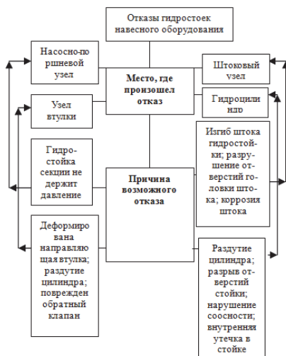
Рис. 1. Отказы гидростоек
