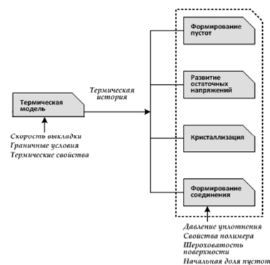
Рис. 3. Схема моделирования процесса выкладки лент с использованием лазерного нагрева
