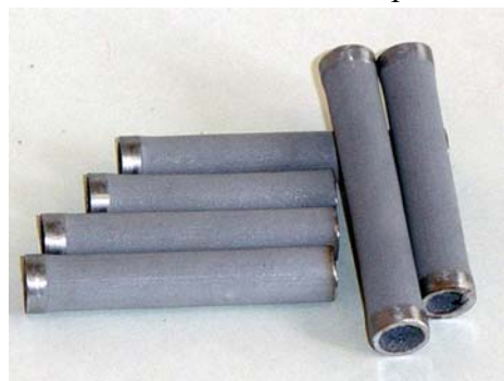
Рис. 1. Общий вид трубок длиной 80 мм из порошка фракции 60-100 мкм
