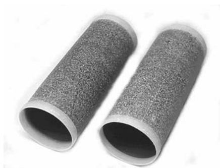
Рис. 1. ТОЭ на несущем электролите YSZ (170 мкм) с LSM-электродами (20 мкм).
