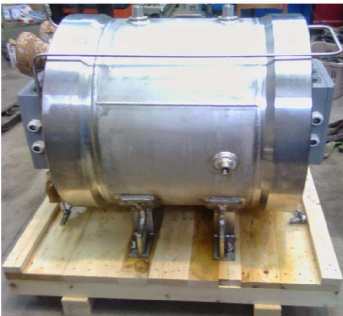
Рисунок 5. Ener Blue «Zero Pressure Stack» для электролизера 15 Нм<sup>3</sup>/ч 60 бар
