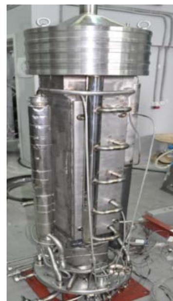
Рисунок 2 - Внешний вид моноблочного конвертора
