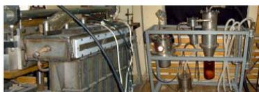
Получение нанопорошка 8,5YSZ лазерным испарением (CO<sub>2</sub>)
