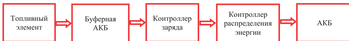
Рисунок 3 – Схема интеграции топливного элемента в состав энергоустановки
