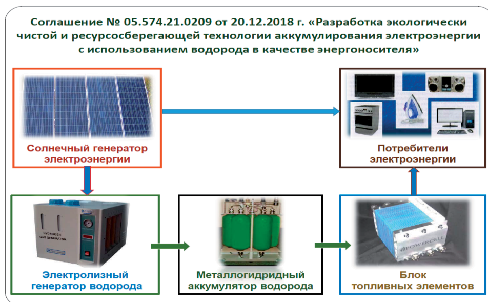
Рис. 4. Система аккумулирования электроэнергии с использованием водорода как энергоносителя.
