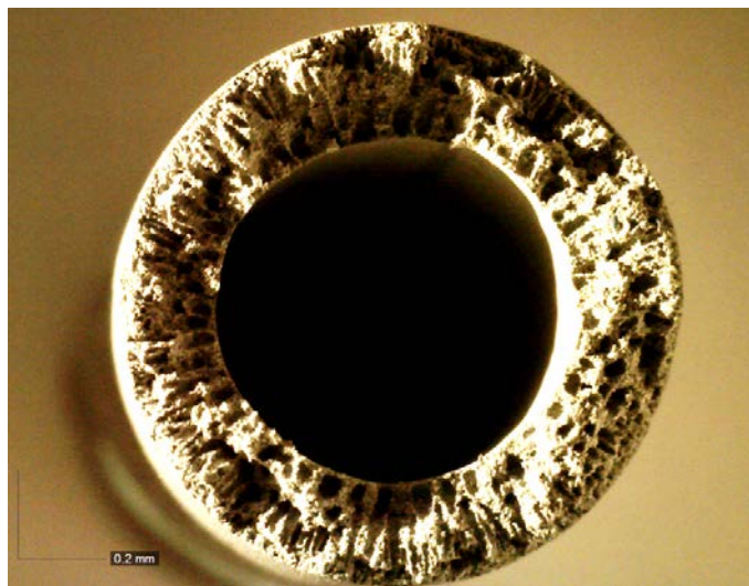
Рисунок 1. Микротрубчатая анодная подложка диаметром 7 мм.
