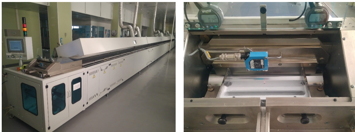
Рисунок 1. Фотография линии для литья на движущуюся ленту (KEKO Equipment) в АО «НЭВЗ-Керамикс»
