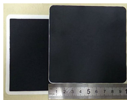
Рисунок 2. Фотографии мембранно-электродных блоков ТОТЭ: переход на мембранно-электродный блок ТОТЭ размером 100 \times 100 \text{ мм}^2 с увеличенной площадью катода.
