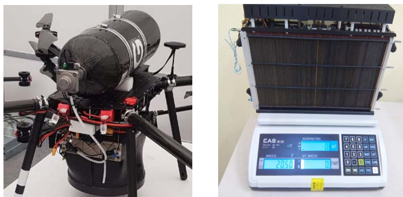
Рисунок 3. Облегченная энергосистема на ПОМ ТЭ с прямой подачей воздуха ( W_m=700 Вт час/кг) мощностью P=2 кВт на квадрокоптере («BM Power», Россия), БТ ( P_m=1 кВт/кг).
