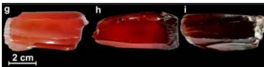
Рисунок 2. Фотография кристаллов: g – 8Sc1CeSZ (91 мол. ZrO_2 + 8 мол.% Sc_2O_3 + 1 мол.% CeO_2 , здесь и далее состав кристаллов представляется в таком формате), h – 9Sc1CeSZ , i – 10Sc1CeSZ [13]
