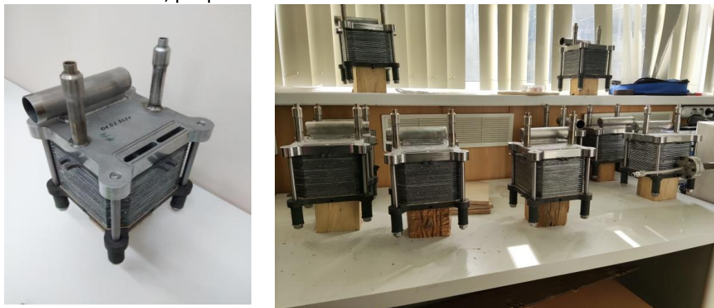
Рисунок 1 – Фотографии стеков с ТОТЭ планарной геометрии на несущем электролите С целью повышения удельной мощности и понижения рабочей температуры
