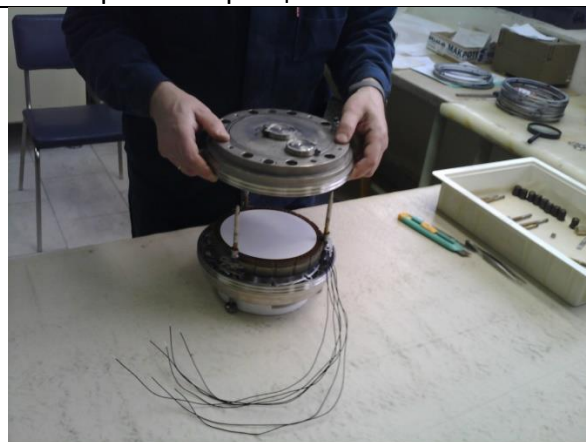
Рисунок 3 – Сборка батареи электролизера
