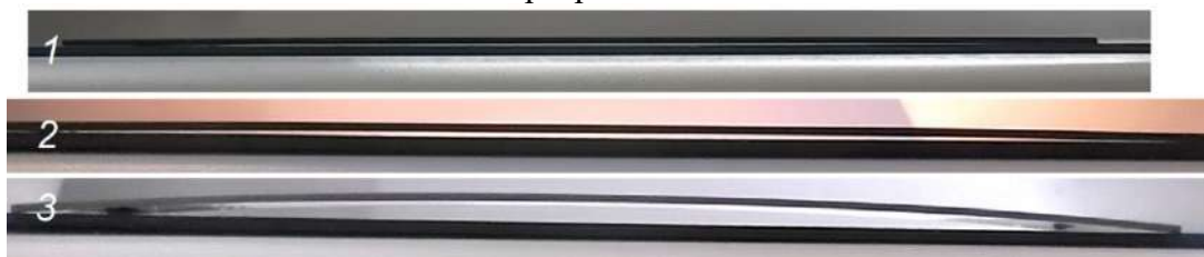
Рисунок 1 – Вид сбоку на исходную анодную подложку (1), после нанесения YSZ (2), после отжига при 1200°C (3). Образец 3 (Таблица 1), электролит на верхней стороне.
