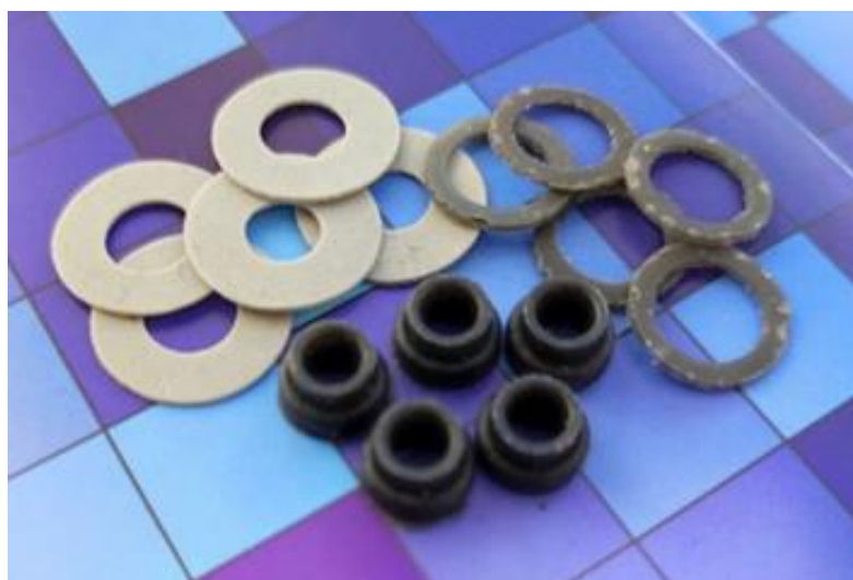
Рисунок 2 – Изделия из стеклогерметика для коммутации твердооксидных топливных элементов, полученные методами 3D печати и штампования.
