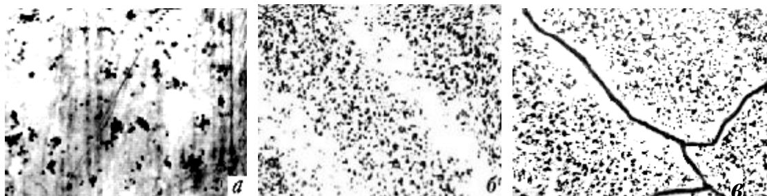
Рис. 2. Автордиограммы-реплики ( ^{63}\text{Ni} ), снятые в железе параллельно поверхности при магнитноимпульсном воздействии (а), \times 9800 , и в направлении деформации под действием ударного сжатия (б) и электрогидроудара (в), \times 4800
