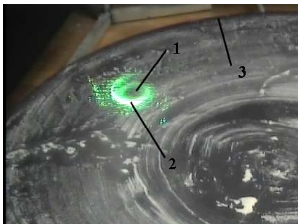
Рис.1. Типичный кадр с изображением поперечного сечения воронки вихря (расстояние от лазерного ножа до поверхности равно 100 мм): 1 – внутренняя полость вихря («глаз вихря»); 2 – стенка вихря; 3 – край подстилающей поверхности. Размер изображения – 500x370 мм.
