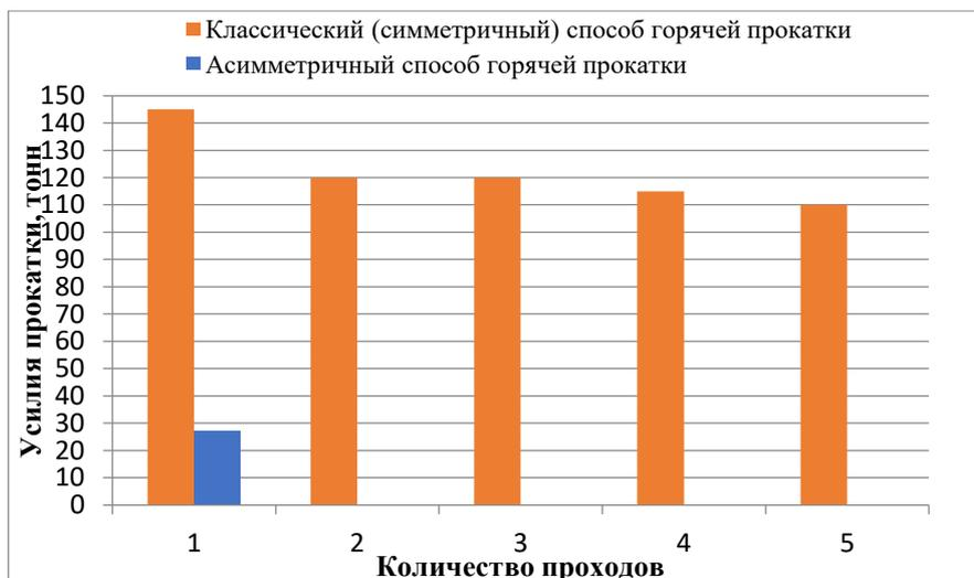
Рис. 1. Сравнение усилий прокатки при симметричном и асимметричном способах горячей прокатки при температуре 1100 С° быстрорежущей стали Р6М5 с 3,15 мм до 1 мм
