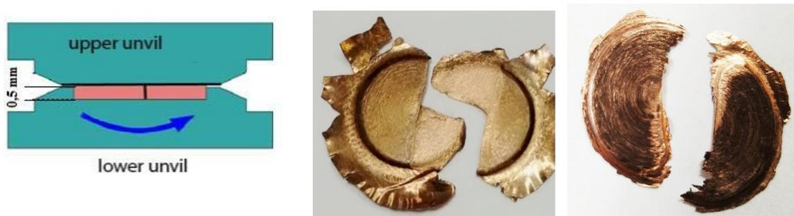
Рис. 1. (а) Схема «совместного ИПДК двух половинок» для определения проскальзывания при ИПДК; (б) вид половинок Cu после совместного ИПДК  $n=1/4$  (показывает отсутствие проскальзывания); (с) образец Cu после ИПДК  $n=10$ , разрезан на половинки, и те же половинки после последующего совместного ИПДК  $n=1$  (вид показывает тотальное проскальзывание)
