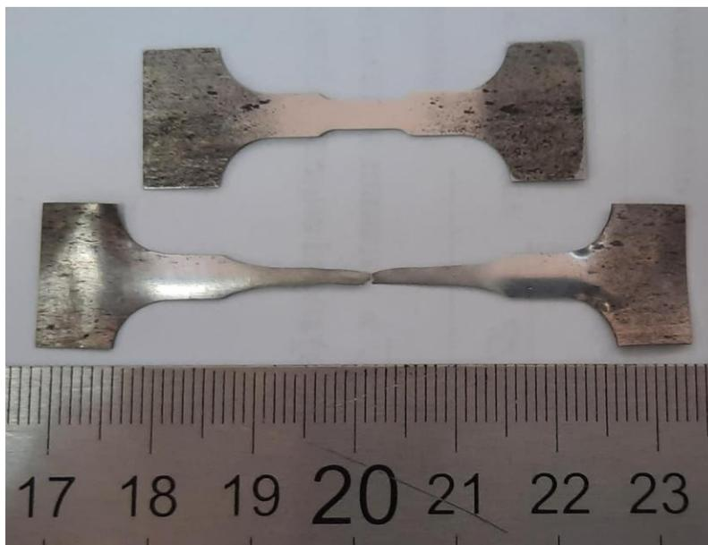
Рис. 1. Вид образца после механических испытаний при температуре 300°C
