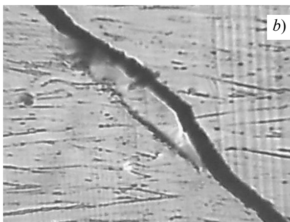
Трещина в плоскости (111) монокристалла \text{Ni}_2\text{MnGa} (оптическая микроскопия \times 500 ): a – участки скольжения в плоскости (010); b – случай огибания структурной неоднородности
