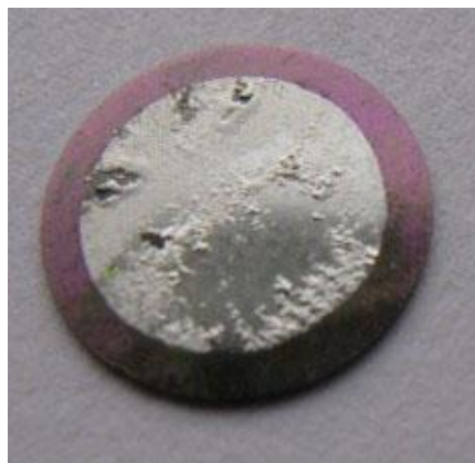
Рисунок 2 - Внешний вид образца Co (0,5 мкм) /ЦТС (400 мкм) после сглаживания поверхности подложки ЦТС путём напыления сглаживающего слоя TiO_2 в течение 60 мин и распыления поверхности в течение 30 мин
