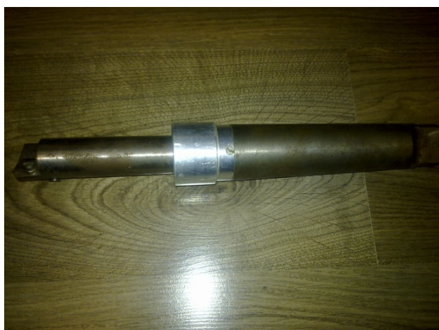
Фиг. 2 Динамометричен инструмент 1 – тяло; 2 – направляваща пластина; 3 – кожух; 4 – винт; 5 – модул за междинна пластина; 6 – модул за периферна пластина; 7 – режеща пластина; 8 – винт; 9 – винт
