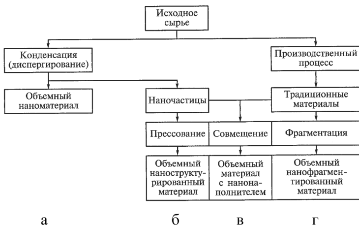
Рисунок 1. Технологии консолидации наночастиц: а – предлагаемая технология; б, в, г – общепринятые технологии
