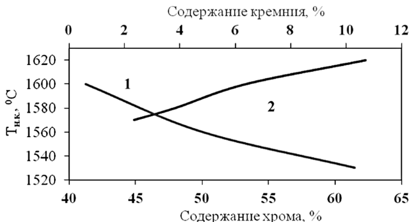
Рисунок 1. Зависимость температуры начала плавления образцов высокоуглеродистого феррохрома от содержания: 1 - кремния (при содержании ~53 % Cr, ~7,5 % C; Fe - остальное) и 2 - хрома (при содержании ~0,3 % Si, ~7,5 % C; Fe - остальное)
