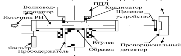
Рис. 2 Сравнение рентгенооптических схем традиционного РФА ПВО (а) и РФА ПВОВР (б)
